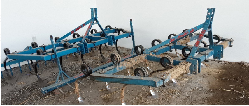
صورة عدد3: آلة من نوع الشيزل الخفيف (أطراف على شكل طير الحمام) لحراثة المعاودة
