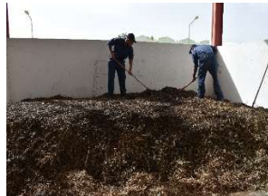
Mise en andains des déchets broyés
